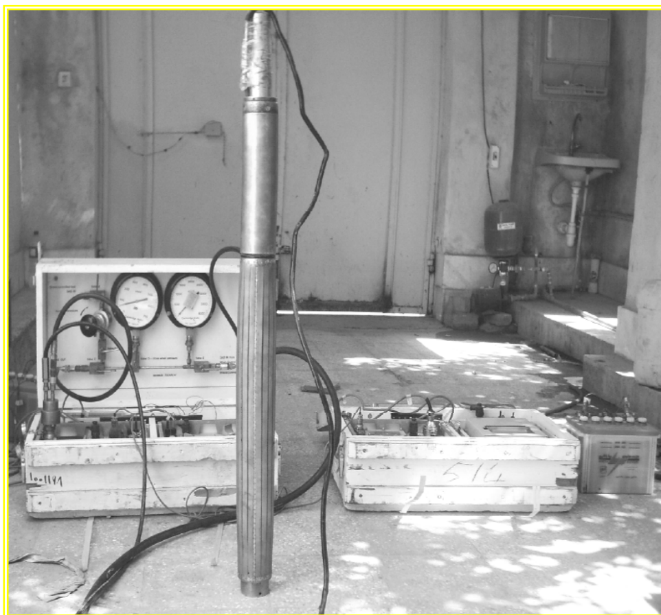
شکل ۳-۷- پرسیومتر خود حفار و تجهیزات مربوطه [۸۴]
